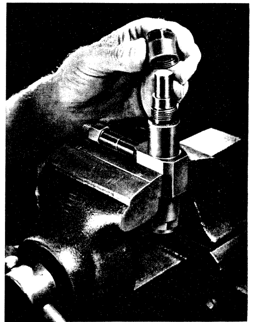
Bild 4: Abnehmen der Überwurfmutter
