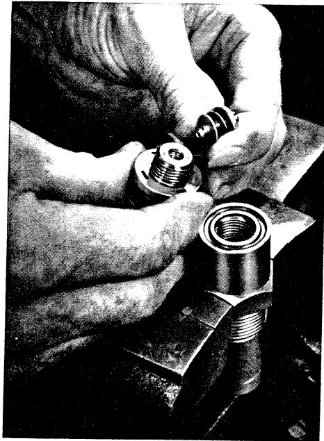
Bild 6: Einstellen des Düsenöffnungsdruckes durch Einsetzen von Beilegscheiben
