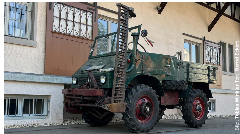
Unimog 411 , Baujahr 1959, OM 636 (mit Bosch-Ausrüstung), 30 PS/22 kW, Ausstattung ab Werk: Busatis-Mähwerk mit pneumatischer Aushebung und Antrieb durch die Frontzapfwelle, hochgelegte Luftansaugung auf der Fahrerseite und Verlagerungsgetriebe am Heck.
