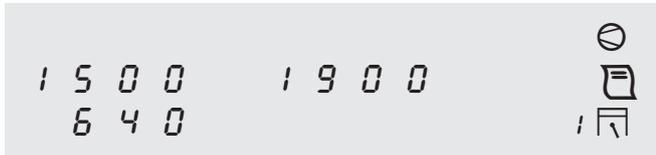
ii Das Drehzahlfenster kann durch Drücken der Taste
