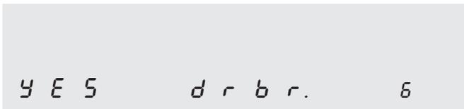
Es wird festgelegt, ob die Mindestdrehzahl für die Leerlaufmessung und die vorgewählte Drehzahl für die Messung bei erhöhter Leerlaufdrehzahl per Tastendruck überbrückbar sein soll.
