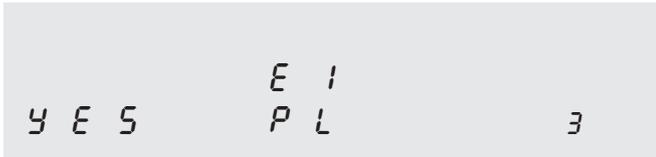
Es wird festgelegt, ob das Protokoll eine Zeile mit einem Text enthält, in der der Bediener die Fahrgestellnummer des geprüften Fahrzeugs von Hand eintragen kann. Der Text **Fahrgestell-Nr.** wird vom Bosch-Kundendienst mit dem Datenterminal oder über PC mit KD-Software (ab Ende 1997) eingegeben.
