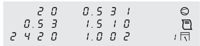
Nach der Gaslaufzeit werden automatisch die Messwerte der zweiten Messung gespeichert, das Protokoll ausgedruckt und die Messung beendet.
