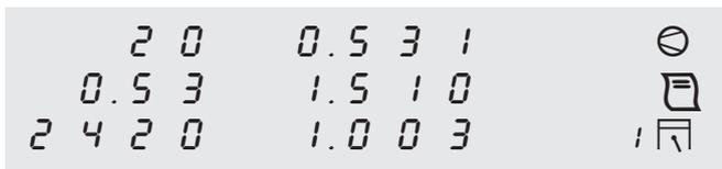
Nach der Gaslaufzeit der Messung bei erhöhter Leerlaufdrehzahl wird **automatisch** zur Messung bei Leerlaufdrehzahl weitergeschaltet.
