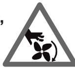
Bei nicht gegen wegrollen gesicherten Fahrzeugen besteht z.B. die Gefahr gegen eine Werkbank gedrückt zu werden. An laufenden aber auch an stehenden Motoren gibt es drehende und bewegte Teile (z.B. Riementriebe), die zu Verletzungen an Fingern und Armen führen können. Besonders bei elektrisch betriebenen Lüftern besteht die Gefahr, dass bei stehendem Motor und ausgeschalteter Zündung unerwartet der Lüfter einschalten kann.
