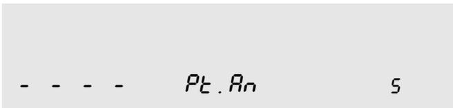
Mit Taste  $\square$  (8) bestätigen, mit Taste  $\Rightarrow$  (7) oder Taste  $\ominus$  (9) Anzeige auf YES setzen und nochmal mit Taste  $\square$  (8) bestätigen.
