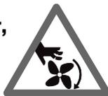
Bei nicht gegen wegrollen gesicherten Fahrzeugen besteht z.B. die Gefahr gegen eine Werkbank gedrückt zu werden. An laufenden aber auch an stehenden Motoren gibt es drehende und bewegte Teile (z.B. Riementriebe), die zu Verletzungen an Fingern und Armen führen können. Besonders bei elektrisch betriebenen Lüftern besteht die Gefahr, daß bei stehendem Motor und ausgeschalteter Zündung unerwartet der Lüfter einschalten kann.
