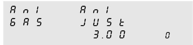
Das Gerät kommt in die Anwärmzeit für die Prüfgasjustierung.
