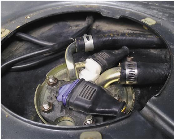
Kabel und Steckverbindungen okay? Falls eine Vorförderpumpe installiert ist, prüfen Sie die Anschlüsse: Liegt hier ein Defekt vor, können Aussetzer infolge Dampfblasenbildung die Folge sein!
