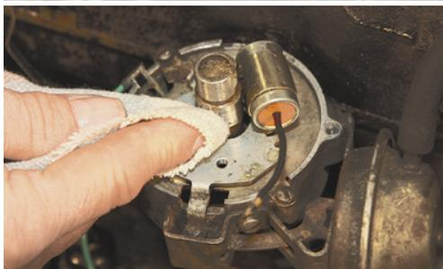
Man löst die Befestigungsschraube und hebt die Kontakte von der Grundplatte ab. Letztere reinigt man ebenso gründlich wie die Nockenbahn auf der Welle. In der Nahaufnahme ist der Kontaktabbund gut zu erkennen
