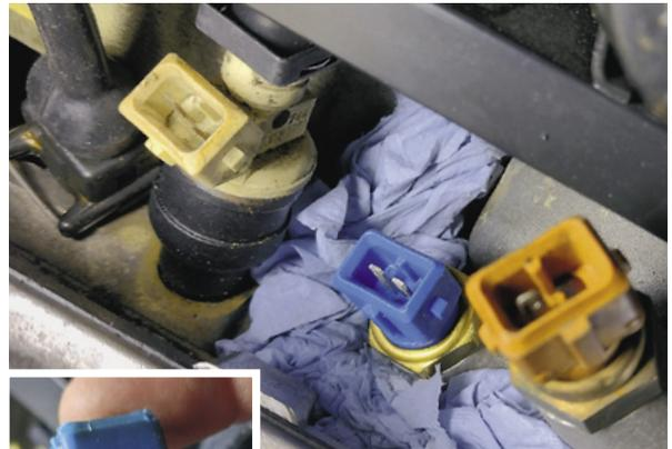
Der Motronic-Temperaturfühler ist leicht am blauen Anschluss zu erkennen: Altersbedingt liefert er gern falsche Werte. Auch hier ein Tipp: die Prüfung per Ohmmeter
