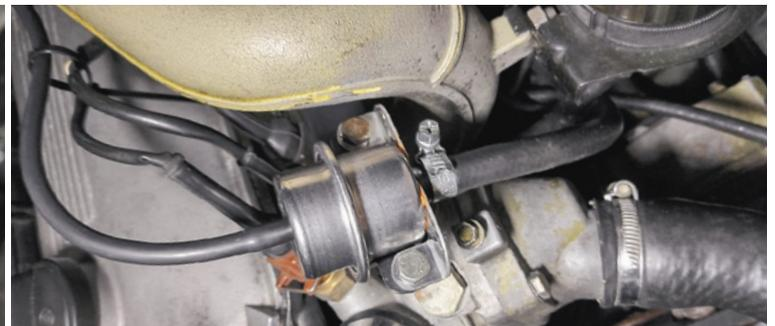
Für den konstanten Systemdruck der Einspritzung (je nach Motortyp 2,5 oder 3,0 bar) sorgt der Membran-Druckregler, der im Verteilerrohr sitzt. Ein Indiz dafür, das Reglerfeder oder Membran schlapp machen, sind ständige Startprobleme bei kaltem Motor
