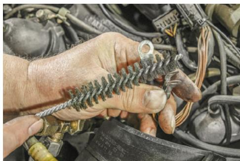
Drahtbürste oder ähnliche adäquate Mittel sorgen dafür, dass alle Korrosionsspuren restlos beseitigt werden
