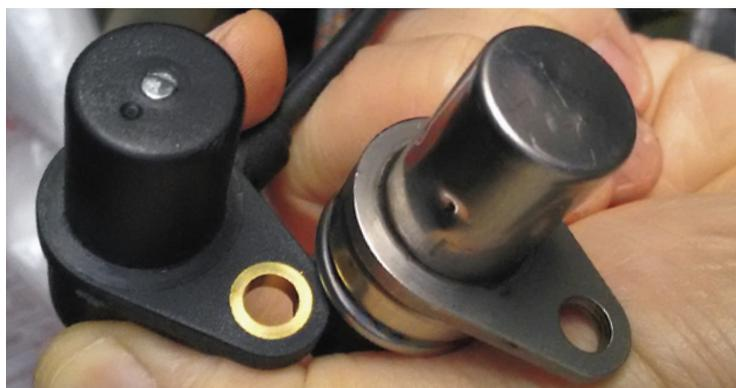
Gibt die Motronic (sporadisch) weder ein Zünd- noch ein Einspritzsignal ab, obwohl offensichtlich kein Fehler auf beiden Seiten vorliegt, ist der Drehzahl- und Bezugs-markengeber oft der Übeltäter. Rechts: seine typische Position am Inkrementenkrans
