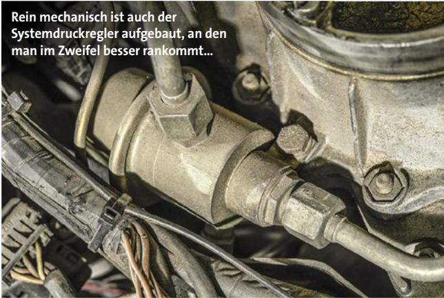
Rein mechanisch ist auch der Systemdruckregler aufgebaut, an dem man im Zweifel besser rankommt...
