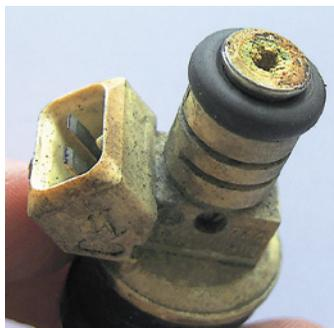
Good Vibrations? Die angetakteten Einspritzdüsen sollten vibrieren. Im Zweifel: Widerstand mit Ohmmeter messen!
