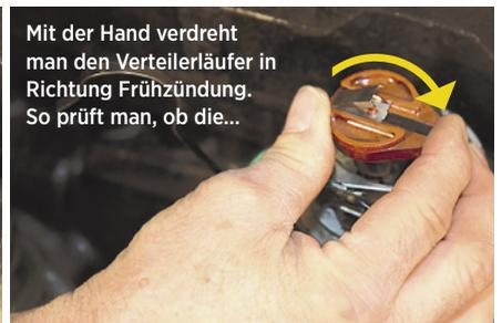
Mit der Hand verdreht man den Verteilerläufer in Richtung Frühzündung. So prüft man, ob die...
