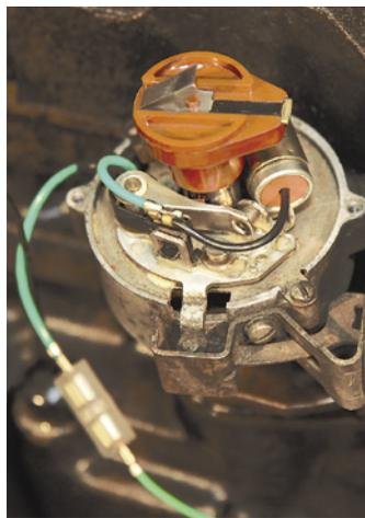
Der Verteilerläufer (auch Finger genannt) lässt sich von Hand einfach nach oben abziehen
