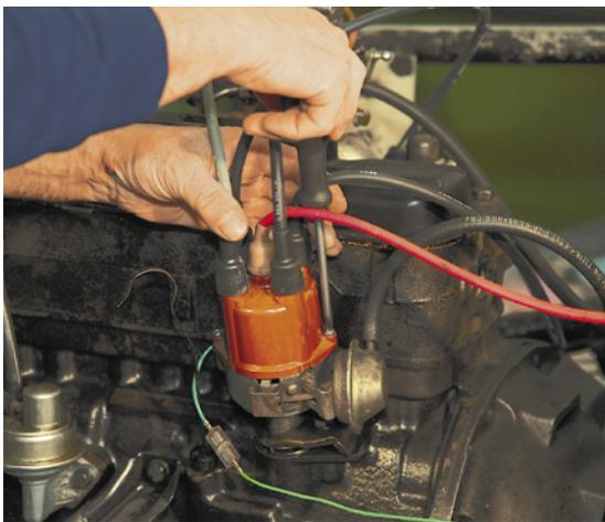
Zunächst nimmt man die Verteilerkappe ab. Zu Schulungszwecken ist das Kabel der Klemme 4 rot und das Zündkabel des ersten Zylinders grau markiert
