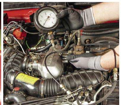
Mit dem Manometer zur Sache: Wie steht's um die Druckverhältnisse im Kraftstoffsystem?
