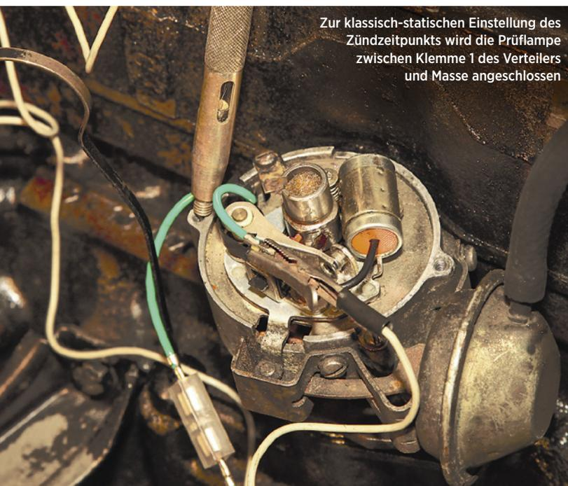
Zur klassisch-statischen Einstellung des Zündzeitpunkts wird die Prüflampe zwischen Klemme 1 des Verteilers und Masse angeschlossen
