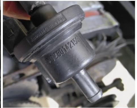
Kann Falschluff ziehen: Das unscheinbare Ventil der Tankentlüftung, das bei Kat-Versionen in der Anbindung des Aktivkohlebehälters zum Ansaugtrakt sitzt
