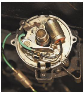
Die neuen Kontakte werden zunächst nur leicht festgeschraubt, damit sie sich zum Einstellen noch bewegen lassen. Dabei greift der Schraubendreher in eine Kerbe am Kontakthalter und stützt sich an zwei Punkten auf der Grundplatte ab. Das Gleitstück muss auf der Nockenspitze stehen
