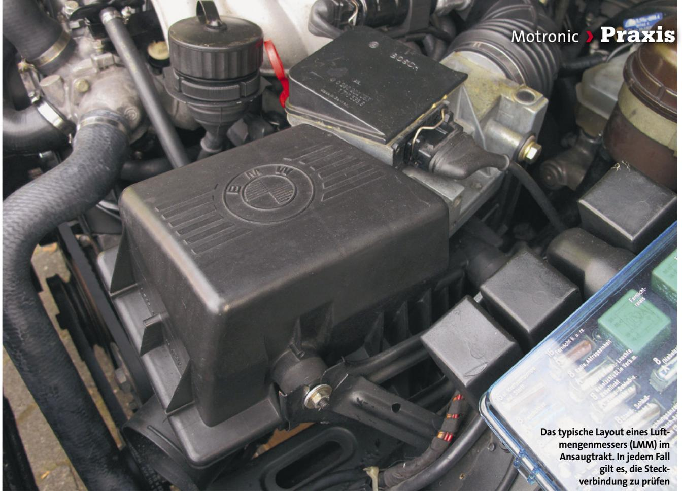
Das typische Layout eines Luftmengenmessers (LMM) im Ansaugtrakt. In jedem Fall gilt es, die Steckverbindung zu prüfen
