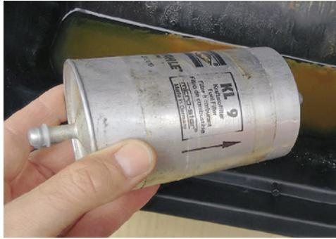
Aller Laster Anfang: Auf der Einspritzseite der Motronic ist die Spritversorgung das A und O. Die Funktion der Kraftstoffpumpe (die mit einer Vorförderpumpe im Tank kombiniert sein kann) sollte stets gewährleistet sein. Klar ist: Ein verschleppter Filterwechsel kann üble Folgen fürs ganze System haben, siehe auch Thema Einspritzdüse!
