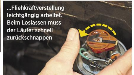
...Fliehkraftverstellung leichtgängig arbeitet. Beim Loslassen muss der Läufer schnell zurückschnappen
