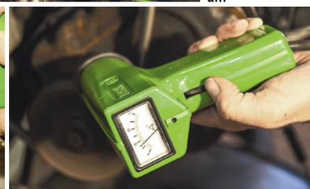
Der Sollwert der maximalen Frühzündung wird an der Pistole eingestellt. Dann fluchtet die OT-Kerbe
