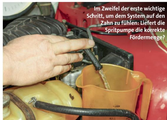
Im Zweifel der erste wichtige Schritt, um dem System auf den Zahn zu fühlen: Liefert die Spritpumpe die korrekte Fördermenge?
