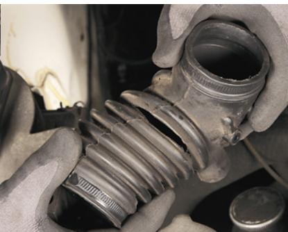
Die angesaugte Luftmenge ist die maßgebliche Steuergröße für die Einspritzseite: Falschlucht im Ansaugtrakt hinterm LMM (Bild oben) aber fatal...
