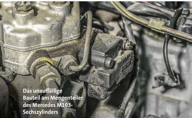
Das unauffällige Bauteil am Mengenteiler des Mercedes M103-Sechszylinders
