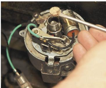
Dieser Schmierfilz dient als Speicher für etwas Öl, das den Verdrehmechanismus der Verteilerwelle beweglich hält
