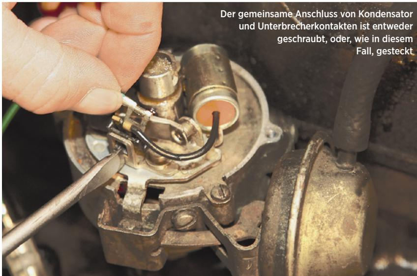
Der gemeinsame Anschluss von Kondensator und Unterbrecherkontakten ist entweder geschraubt, oder, wie in diesem Fall, gesteckt
