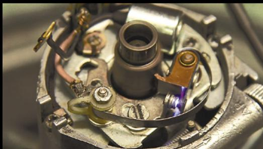
Masse). Dann löst man die Klemmschraube des Verteilers, und dreht diesen zunächst in Drehrichtung des Läufers, wobei die Prüflampe leuchtet. Nun dreht man den Verteiler in Gegenrichtung, bis zu dem Punkt, an dem die Prüflampe erlischt und zieht dann die Klemmschraube des Verteilers wieder fest. Diese Methode nimmt nur wenige Minuten in Anspruch und war bis zum Einzug des Stroboskops in den Werkstattalltag gang und gäbe.
