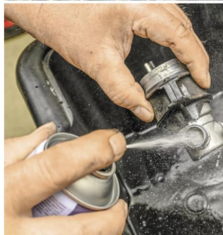
Nach Jahrzehnten Dauereinsatz verharzt das ausgefeilte elektromechanische Bauteil gern mal. Für Abhilfe kann so ein intensives Kurbad mit Bremsreiniger sorgen!
