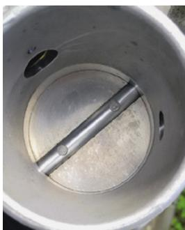
Wie sieht's im Saugrohr mit der Drosselklappenstellung aus? Ist die Klappe sauber justiert, lässt sich auch der Drosselklappenschalter derart ideal einstellen, dass hier der typische dezente Klickton des Leerlaufanschlags zu hören ist...
