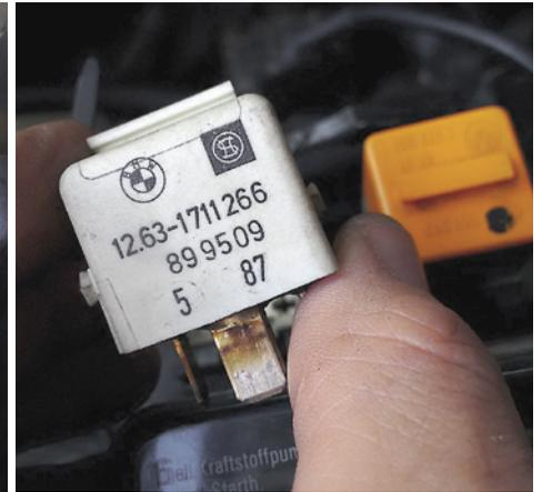
Sind die zugehörigen Motronic-Relais noch original? Fällt etwa das Kraftstoffpumpenrelais aus, ist die Benzinzufuhr abrupt unterbrochen...
