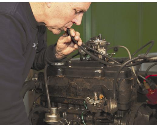
Man saugt am Schlauch für die Unterdruckverstellung und beobachtet, ob...
