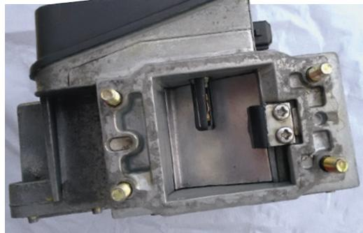
Ein kerngesunder, grundgereinigter LMM: Die typische Stauklappe sollte leicht beweglich sein, der Temperaturfühler (re. im Detail) frei von Schmutz und Ablagerungen. Am LMM-Anschluss (li.) lässt sich der Widerstand messen
