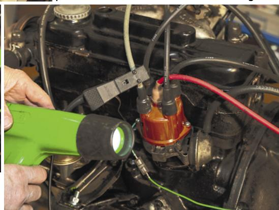
Die Zündlicht-Pistole setzt den Impuls des ersten Zylinders in Stroboskopblitze um
