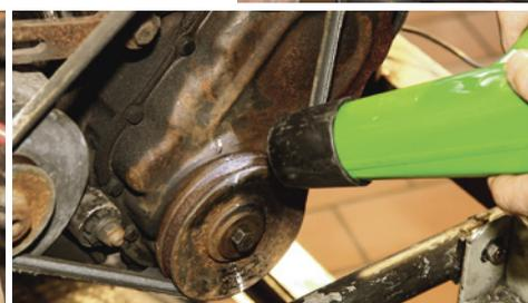
Fluchten die Markierungen? Der Lichtblitz lässt die drehende Keilriemenscheibe scheinbar stillstehen
