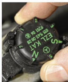
Steht der typische „Abgleichstecker“ der KE3-Jetronic etwa auf N? Im Mercedes-Motorraum wird die Einspritzanlage damit auf die Kraftstoffqualität angepasst
