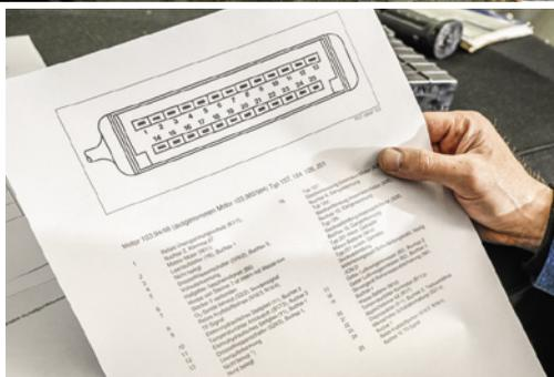
Nie ohne Plan! Die exakte Steckerbelegung geht aus den Werksunterlagen hervor, die sich leicht organisieren lassen
