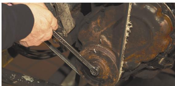
Die Markierung auf der Keilriemenscheibe muss mit der Nase am Motor fluchten
